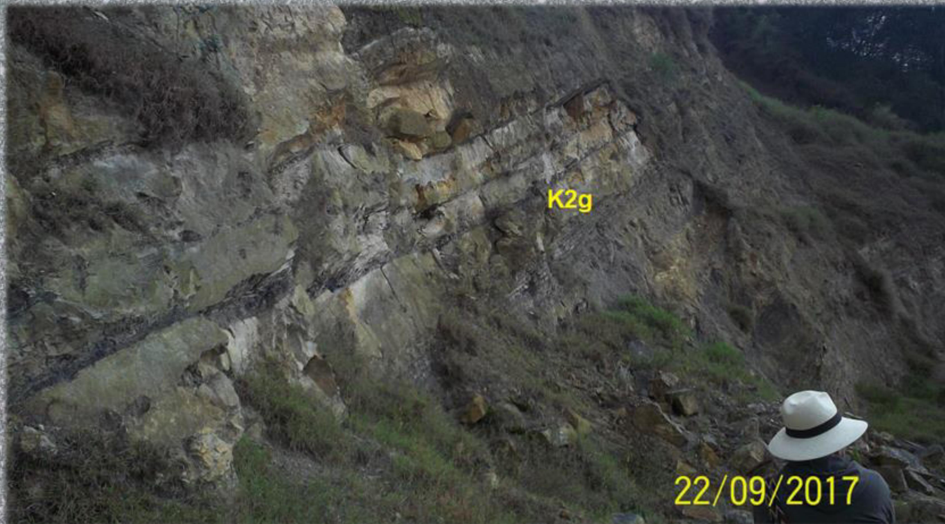
Rocas de Cretácico, Contacto entre la Formación Plaeners y Arenisca Dura, Antigua cantera el Paraíso Fuente INFORME FINAL DE GEOLOGÍA Y GEOMORFOLOGÍA, RURAL Y LOCAL, MUNICIPIO DE FUSAGASUGÁ, 2018
